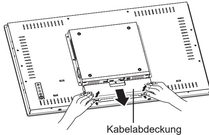
3. Nach Anschluss der Kabel an den geeigneten Anschlüssen und Positionierung aller Kabel unter der Abdeckungsrippe Kabelabdeckung anbringen. Nehmen Sie die Schraube (M3 x 1) aus der Zubehörschachtel und befestigen Sie sie an der Kabelabdeckung und am Display.
