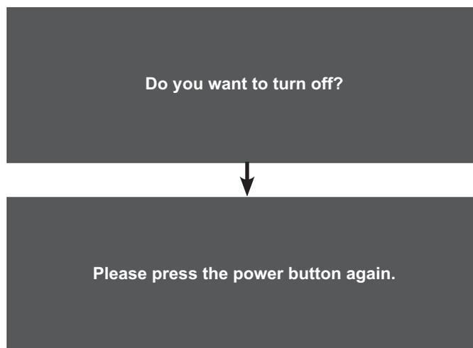
**Hinweis:** Das LCD-Display verbraucht nach wie vor etwas Strom, solange der Netzstecker eingesteckt ist. Zum vollständigen Abschalten ziehen Sie bitte den Netzstecker.
