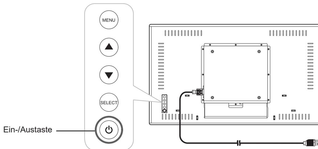
Wenn das LCD-Anzeigegerät eingeschaltet ist, drücken Sie zum Abschalten des LCD-Anzeigegerätes dreimal die Taste
