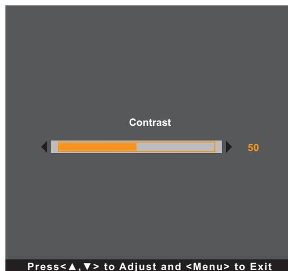
Drücken Sie dann zum Anpassen des Kontrasts des LCD-Anzeigegerätes die Tasten ▲/▼.
